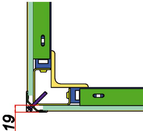
La soluzione prevede il rivestimento esterno totale delle parti strutturali, mediante copertura totale, con profili fermavetro verticali e orizzontali in acciaio verniciati o inox. Il sistema ha un'ottima tenuta all'acqua e non necessita di sigillanti.
