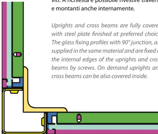
La soluzione prevede il completo rivestimento dei profili strutturali (montanti e traverse) in acciaio con finitura a scelta, i profili fermavetri, con giunzioni a 90° sono forniti nello stesso materiale e vengono fissati ai bordi interni dei profili portanti mediante viti. A richiesta è possibile rivestire traverse e montanti anche internamente.
