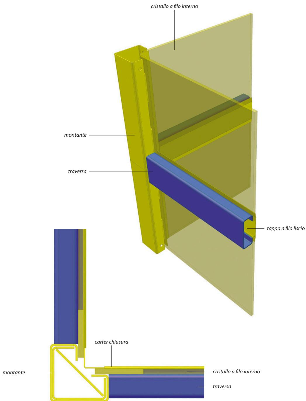
La soluzione, studiata principalmente per piattaforme elevatrici senza pareti o porte di piano, grazie alle sezioni dei profili strutturali ed al rapidissimo sistema di fissaggio dei cristalli, è in grado di garantire, su ogni parete della struttura, un filo liscio e continuo all'interno del vano ed una totale tamburatura dei profili verticali.
